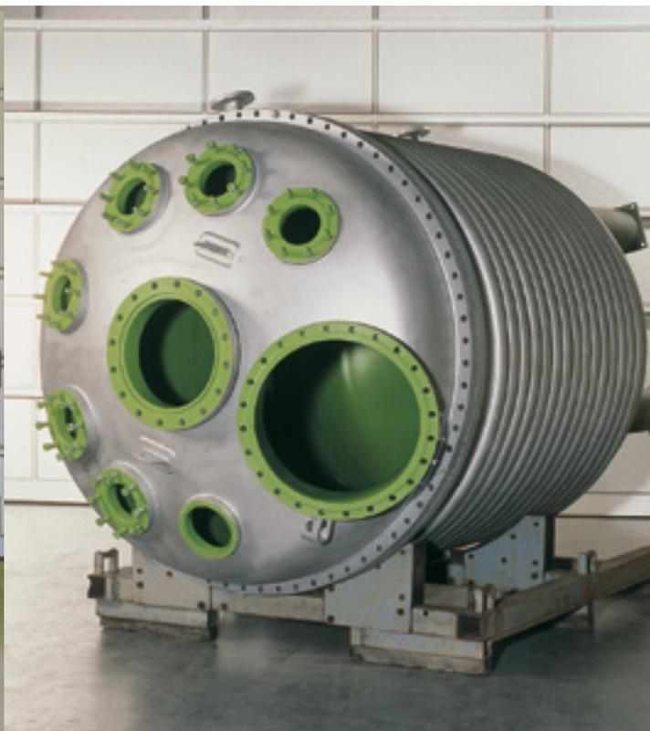
Beim Spritz-Sinter-Verfahren (Airless- und Druckluftverfahren) arbeitet Gutbrod mit Teflon® PTFE und Teflon® FEP. Die Beschichtung wird aufgespritzt und dann bei 220° C bis 420° C „gesintert“.
